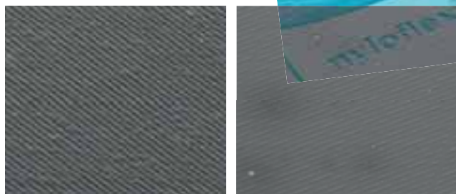
Abb. 2: Sauerstoffeffekt bei der Vollflächenrastrung
