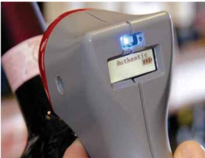
تصویر ۱- اسکنر V400 به همراه سیستم امنیتی Verigard™ امکان تشخیص اصالت بسته‌بندی‌ها و اوراق بهادار را به روش قفل و کلید فراهم می‌آورد.
