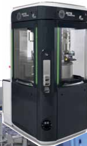
شکل ۲- داخل پوشش‌دهنده: برای اطمینان از اینکه شیشه بعدها با محصول واکنش ندهند، یک لایه محافظ به داخل ظرف پوشش داده می‌شود
