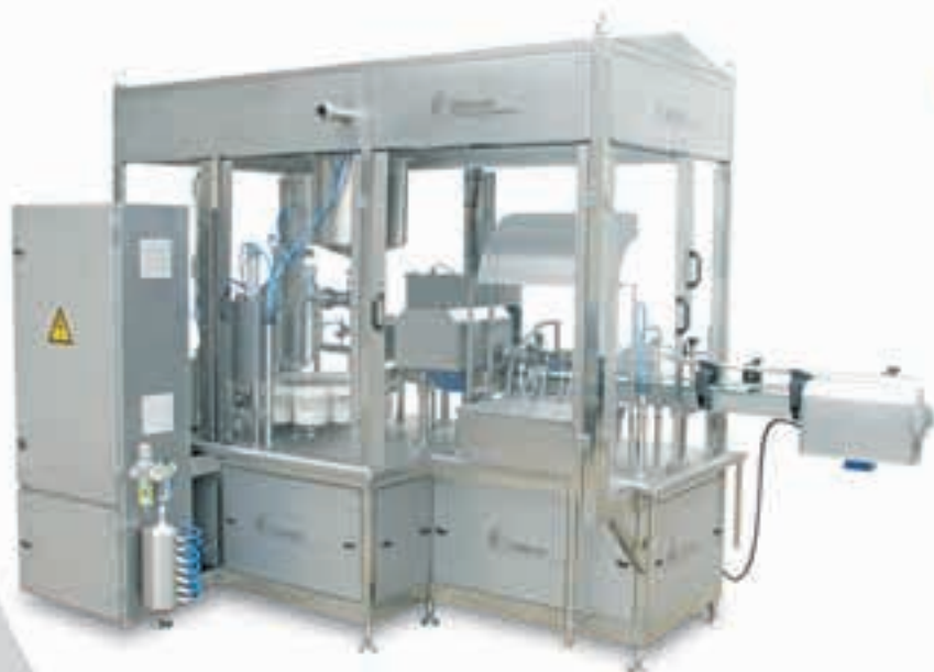
پرکن دیسهای یک نازله تمام اتوماتیک با شستشوی داخلی دیس
