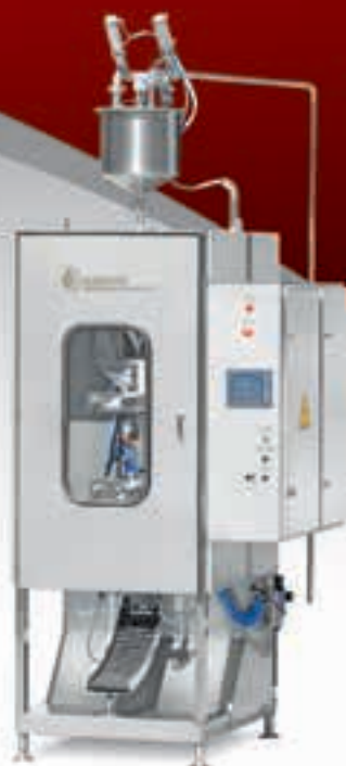
پرکن کیسه‌ای ۱ لیتری و ۵ لیتری جهت شیر - خامه قنادی - آب آشامیدنی
