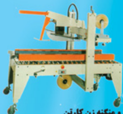
دستگاه چسب زن کارتن حمل از بغل زیر و روی کارتن
