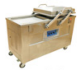
دستگاه وکیوم مواد غذایی نگ کابین و ۳ کابین با قابلیت تزریق گاز DZQ500/258
