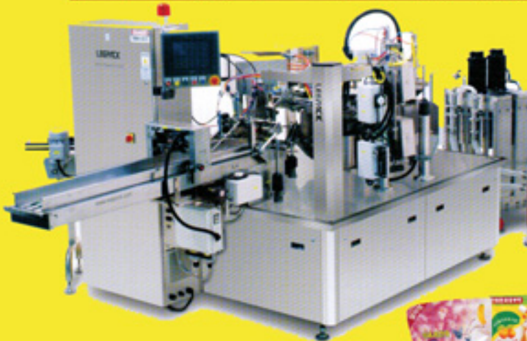
پرکن پاکتهای ۱۰۰۰ - ۵۰۰ - ۲۵۰ میلی لیتر با یک ماشین) در حال کار در کارخانه نگاه تهران
