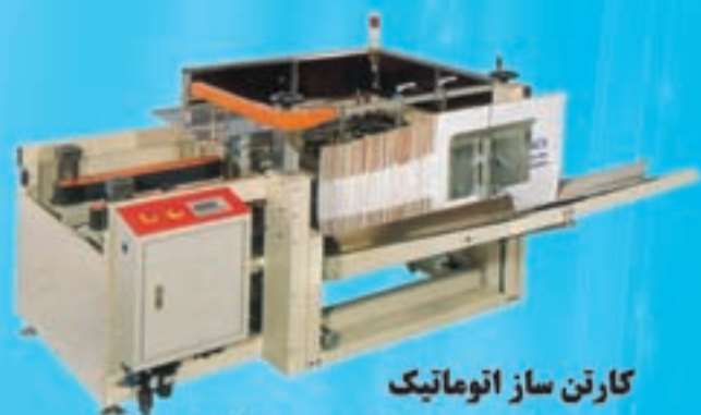
دستگاه چسب زن و منگنه زن کارتن مجهز به درب بندی اتوماتیک
