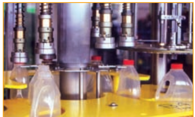
با تغییر "فرم" قابل تعویض (قسمت زرد رنگ)، به راحتی می‌توان ماشین را برای پر کردن بطری‌های مختلف، تنظیم و استفاده کرد
