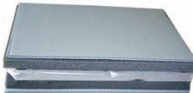
تصویر (۴) - بسته فوم اورتان را بین دو لایه مقوای موجدار چندکاربردی به روش ساندویچی قرار دهید
