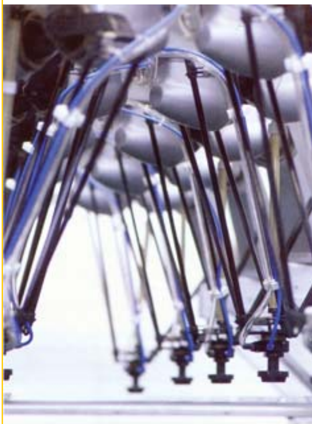
تصویر (۲) - روبات Delta در کارکرد برداشتن و گذاشتن
