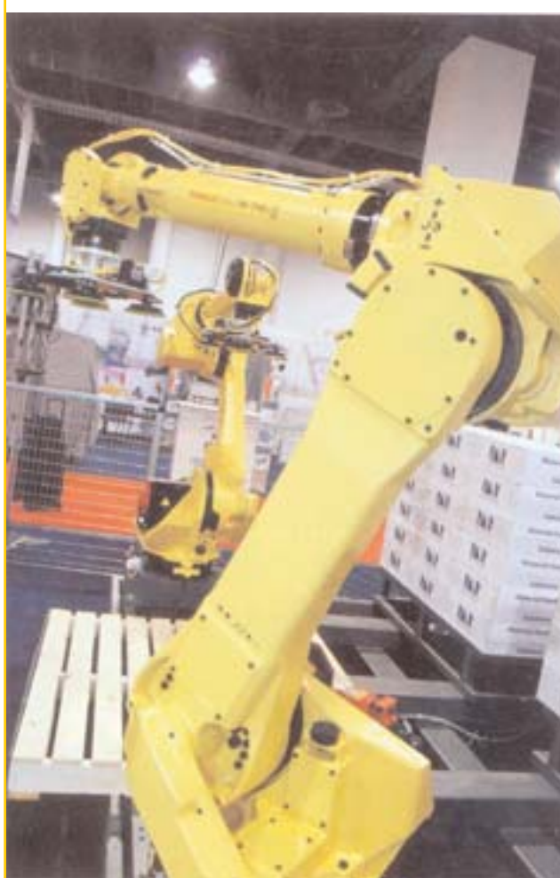
تصویر (۱) - پالت بندی کردن و از پالت خارج نمودن، رایج ترین عملکرد روباتها بشمار می‌آید
