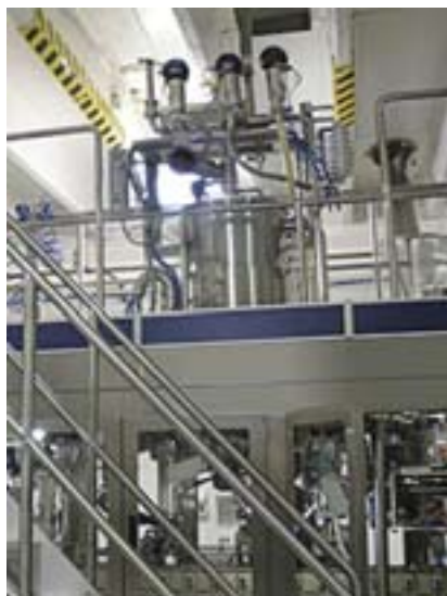
تصویر (۲) - مواد مایع توسط فیلرهای پیستونی محفظه‌ای که در بالای دستگاه form/filler قرار دارد به داخل جعبه‌ها ریخته می‌شود.
