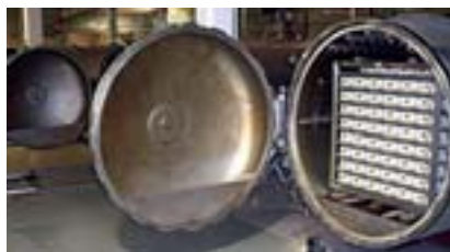
تصویر (۳) - کارخانه چهار قسمت عملیات حرارتی دارد که هر یک دو قفسه از جعبه‌ها را شامل می‌شوند. هر قفسه ۷۵۶ جعبه را در خود جا می‌دهد.
