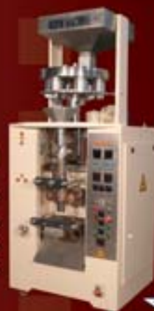
دستگاه بسته بندی گرانول پیمانه ای دوار Model: FM-1008 مناسب جهت بسته بندی انواع حبوبات و خشکبار ماکارونی و تمام دانه های سورت شده
