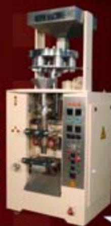
دستگاه بسته بندی گرانول پیمانه ای دوار Model:FM-1008 مناسب جهت بسته بندی انواع حیویات و خشکیار ماکارونی و تمام دانه های سورت شده
