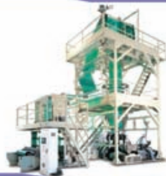
ماشین آلات تولید نایلون چند لایه و عریض کشاورزی
