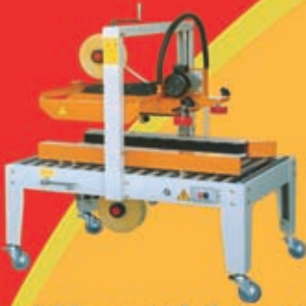
ماشین چسب زنی اتوماتیک زیر و روی کارتن (سه موتورده)
