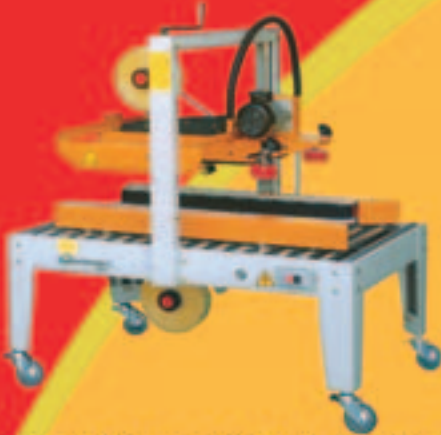
ماشین چسب زنی اتوماتیک زیر و روی کارتن (سه موتوره)
