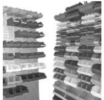
شکل ۸ - استفاده از ظروف سرباز مناسب برای شمارش قطعات صنعتی در انبار
