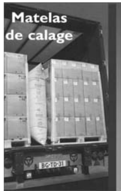
(شکل - ۳) نحوه جلوگیری از جابجایی بسته در داخل کامیون برای دفع ارتعاشات ناگهانی
