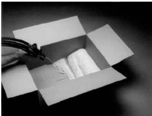
شکل ۲- تصویر یک کالای حساس به ضربه که روش تزریق قالب گیری بسته‌بندی شده است
