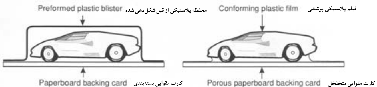
شکل ۱-۱۹: یک بسته‌بندی کارتدار از نوع محفظه برجسته (چپ)، و یک بسته‌بندی از نوع غلاف پوستی
