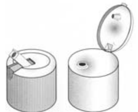
شکل ۱۲-۱۳: یک دربندی از نوع لوله لولادار (چپ) و یک دربندی از نوع اریفیس پوشاننده لولادار (راست)
