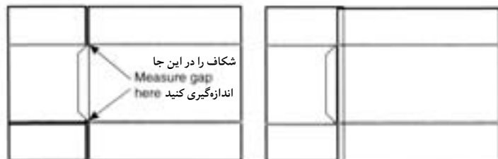
شکل ۱۵-۱۶: محدوددهای مجاز شکافها و روی هم افتادگیها
