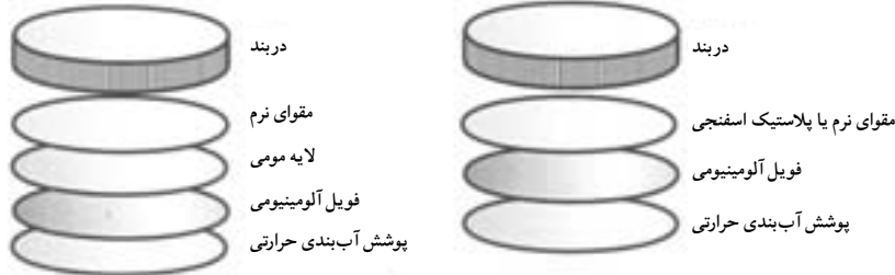
شکل ۹-۱۲: دو نوع سیستم لاینری مورد استفاده در آب‌بندی‌های داخلی به روش آب‌بندی حرارتی القایی
