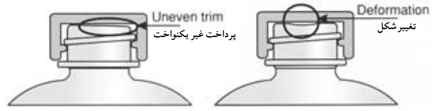
شکل ۵-۱۲: پرداخت غیر یکنواخت یا دیگر تغییر شکل‌های نشیمنگاهی در قسمت انتهایی بطری می‌تواند به نشتی محصول منجر شود.
