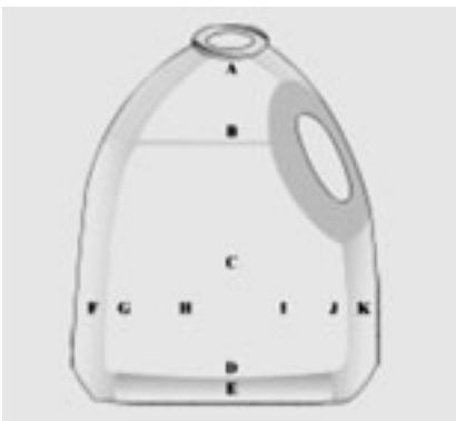
شکل ۱: بطری دو لیتری تولید شده دسته دار با مواد پلی پروپیلن کوپلیمر شفاف با مواد Exact Impact Modifier
