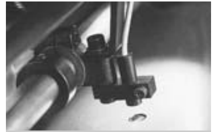
بازرسی "دوبل شیفت" برای اطمینان از عدم ورود دو برگ با هم به درون ماشین در این جا بدون تماس است. سطح ورق هیچ گاه آسیب نمی بیند. زیرا حسگرهای جدید از پرتو نور برای آزمایش ورقهای در حال عبور استفاده می کنند.
