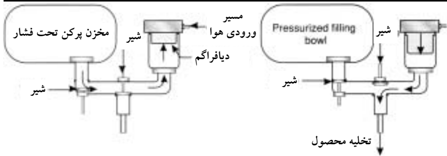
شکل ۱۸-۱۵: دستگاه‌های پرکن دیافراگمی حجم دقیقی از محصول را به درون ظرف تخلیه می‌کند.
