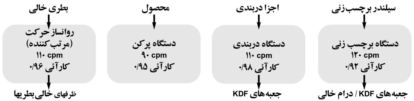
شکل ۱۸-۲- این خط می تواند سریعتر از ۹۰ cpm کار کند، که حداکثر سرعت بخش پرکن است. خروجی واقعی آن عبارتست از:
