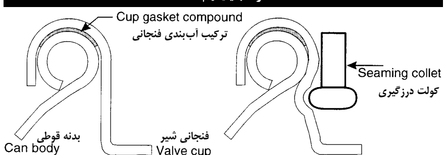
شکل ۷-۲۰: ابعاد پیچش فنجان شیر برای دستیابی به یک آب‌بندی خوب بین فنجان و بدنه ظرف بسیار مهم است
