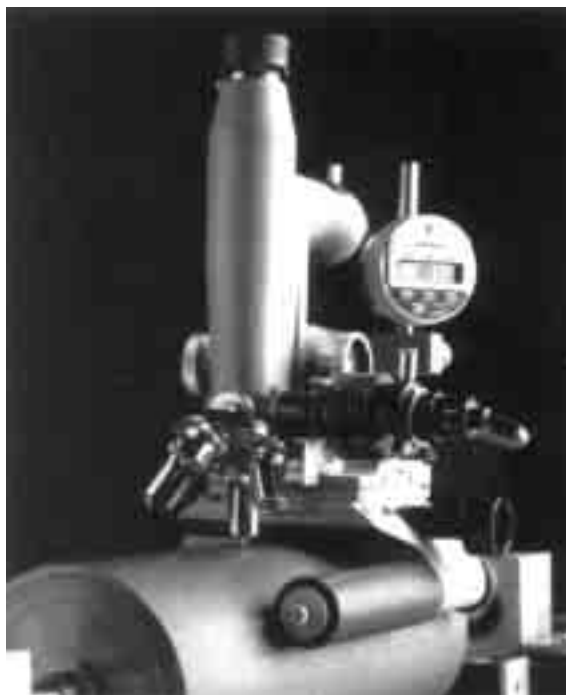
یک نشان دهنده کیفیت (Quality scope) که برای کار بر روی غلتک آنیلوکس طراحی شده است و می توان توسط آن درون هر سل را دید و عمق واقعی آن را محاسبه کرد.
