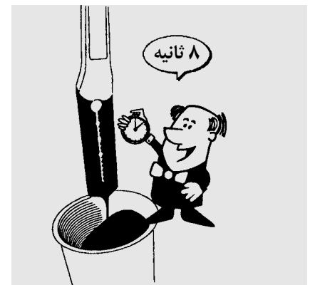
شکل ۸ - نمایشی از هم زدن مرکب و تعیین ویسکوزیته آن توسط تیغه مدرج.
