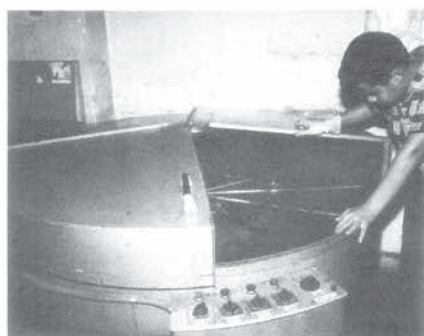
چپ: دستگاه حساس کردن زینک مسی پایین: زینک آلومینیومی روی ماشین چاپ
