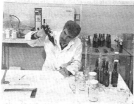
هادی تشکر کارشناس با سابقه واحد بسته بندی، در حال انجام یکی از آزمون‌های دربندی شیشه.
