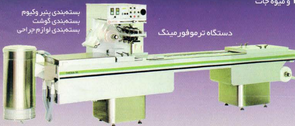
ماشین بسته‌بندی همراه با سیستم توزین و چاپ برچسب برای گوشت، مرغ و میوه جات
